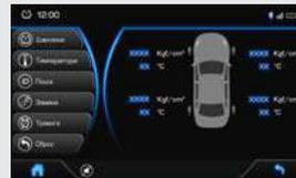
Настройка датчиков температуры и давления воздуха в шинах.
