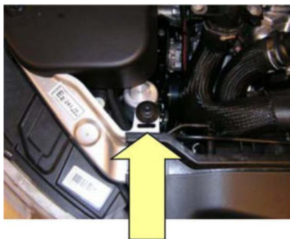
Место установки штатной кнопки капота
