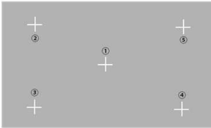
Мы используем функцию калибровки сенсорного экрана, чтобы прикосновения к экрану были более точными. Прикоснитесь к плюсам на экране, чтобы информация о касании была более точной.
