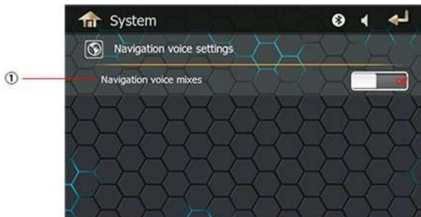
① Комбинация звуков. Когда активирована эта функция, то звук в других режимах, например, при проигрывании мультимедиа файлов, будет уменьшаться при проигрывании звуков навигации.
