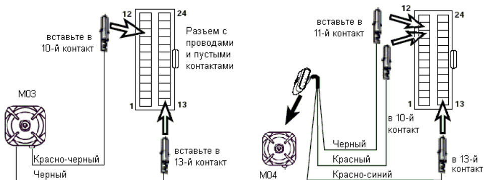
Рис.6. Подключение сирен M03 (А) и M04 (В).
