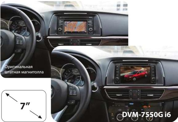
Мультимедийный центр DVM-7550G i6 имеет 7" сенсорный дисплей высокого разрешения, промышленный и высокоточный GPS u-blox чипсет с выходом в интернет, обновленный интерфейс i6 и поддерживает штатные функции:
