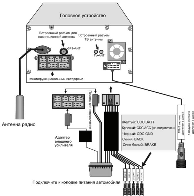
**Внимание:** Для первичного запуска штатного усилителя "Bose", сначала подключите основной разъем питания и включите устройство DVM-7500, затем подключайте аудио-разъем (10 pins).
